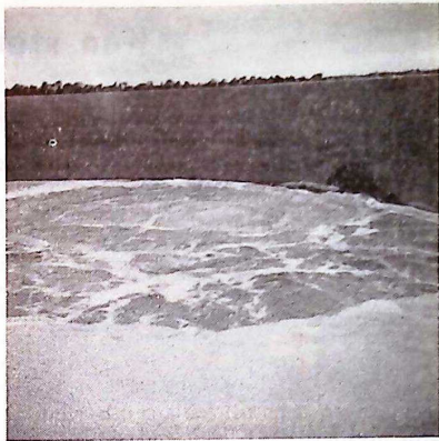
Bild 3. Skuminföring enligt subsurface-metoden.
